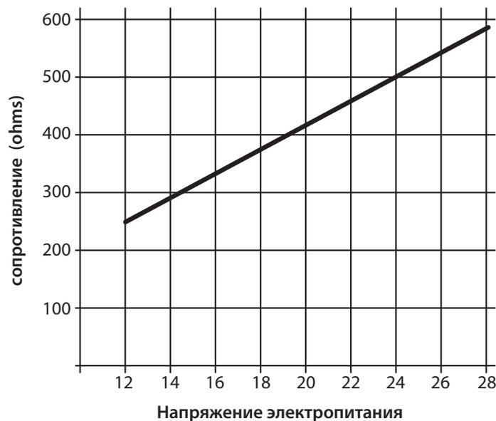
**Рис. 8** Максимальная нагрузка Easidew PRO I.S. - включая сопротивление кабеля
